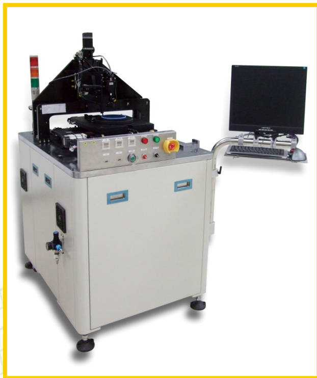
YT 5311 LED Chip/Wafer/Mask 半自動光學檢測系統
