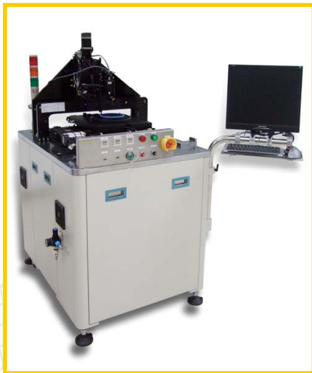
YT 5311 LED Chip/Wafer/Mask 半自動光學檢測系統
