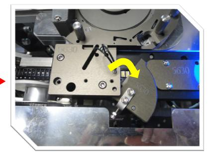
爲轉盤直接置入式將產品置於載帶中,且料件放置不平時,蓋板會自動打 開,沒有吸嘴置入式會對產品造成損傷狀況
