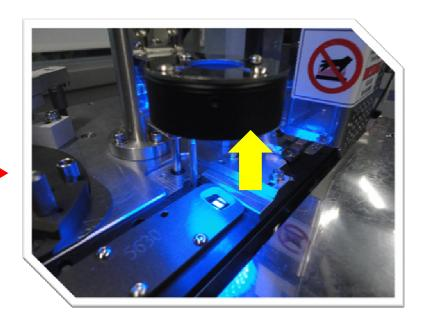
於CCD檢測發現異常時,CCD光源會自動往上昇起,方便操作人員進行NG 料件排除、更換,增進生產效率
